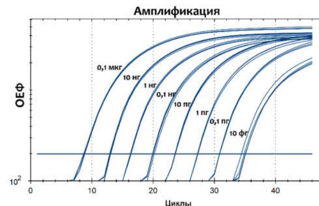
Амплификация фрагмента кДНК гена 18S мРНК в серии 10 кратных разведений от 10 фг до 1 мкг. Длина ампликона – 120 п.н. Реакция проводилась на приборе CFX96 Touch (Bio-Rad).
