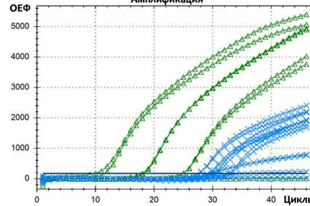
Амплификация серии разведений (от 10<sup>3</sup> до 10<sup>7</sup> раз) реакционной смеси после ПЦР в присутствии дУТФ. Зеленые линии – **БиоМастер HS-qПЦР Hi-ROX (2x)**; синие линии – **БиоМастер UDG HS-qPCR Hi-ROX (2x)**.
