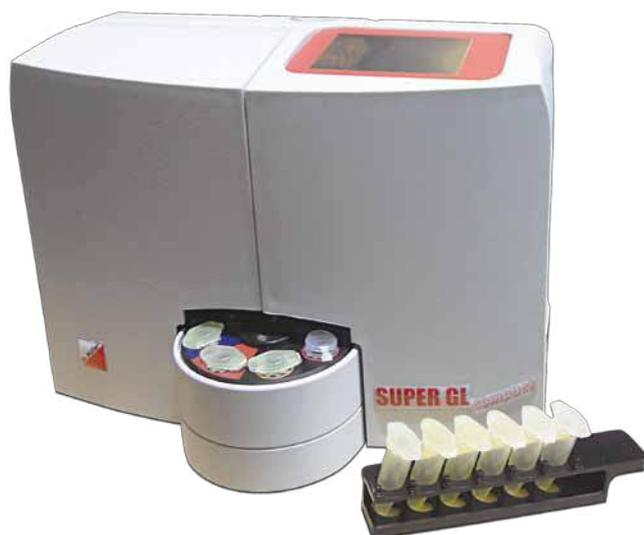
Автоматический анализатор глюкозы и лактата с дополнительной возможностью измерения гемоглобина
