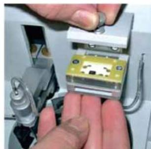
Следует открыть упаковку и извлечь сенсор. Затем, вставить сенсор в откидную крышку отсека контактами вверх и закрыть крышку. Сенсор готов к работе.
