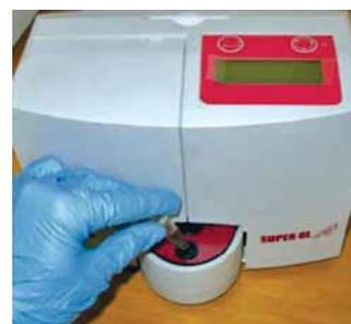
В капилляр производится забор цельной капиллярной крови. Затем, заполненный пробой капилляр опускают в пробирку с системным раствором. Крышку пробирки закрывают, пробирку переворачивают несколько раз. Не менее чем через 30 секунд пробирка помещается в позицию для образца ротора анализатора.
