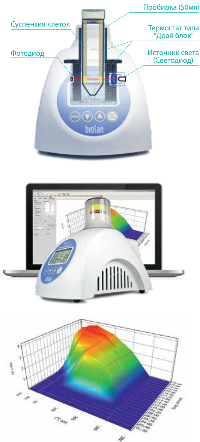
Рис. 1. 3D график кинетики роста E.coli BL21 показывающий эффект разных температур проведённых на 7 RTS биореакторах одновременно
