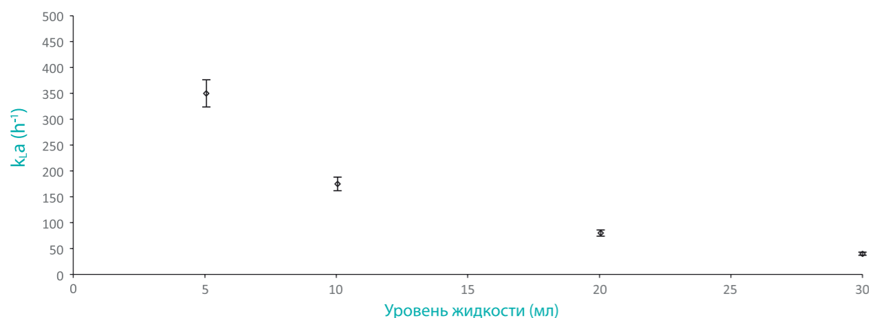
Рис. 3. Влияние различных объемов среды на скорость ее насыщения кислородом в 50 мл TPP Биореакторе при интенсивном реверсивном вращении на RST -1C. Заполнение осуществляли де-ионизированной водой объемом 5, 10, 20 и 30 мл и измерения осуществляли неинвазивным O_2 датчиком и оптикой (PreSens, Германия) при 37 °C, используя метод полного вытеснения растворенного кислорода-азотом. На Рис. 3 представлены средние значения как минимум 5-ти экспериментов, а также их среднеквадратичные отклонения.
