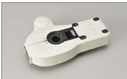
Моторизованное колесо с барьерными фильтрами (Ni-E) Положения барьерных фильтров (7 положений при использовании фильтров 25 мм) можно менять очень быстро: 0,2 - одно положение
