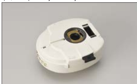
Моторизованная эпилюминесцентная турель (Ni-E, Ni-U) Система подавления шумов обеспечивает высокое соотношение сигнал/шум. Можно установить шесть фильтровых кубов. Можно установить либо эпилюминесцентную насадку, либо насадку для фотоактивации
